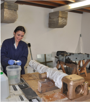
Tratamento de limpeza e estabilização da corrosão do tubo-peça da Peça 7 cm BEM m/1882 e todos os componentes desmontados, estabilizados e tratados individualmente para que mantenham a sua funcionalidade, realizada em 2020 no Núcleo de História Militar Manuel Coelho Baptista de Lima do Museu de Angra do Heroísmo.
