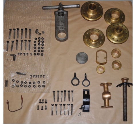
Tratamento de limpeza e estabilização da corrosão do tubo-peça da Peça 7 cm BEM m/1882 e todos os componentes desmontados, estabilizados e tratados individualmente para que mantenham a sua funcionalidade, realizada em 2020 no Núcleo de História Militar Manuel Coelho Baptista de Lima do Museu de Angra do Heroísmo.
